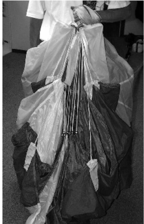
**#10** Ergreifen Sie nun die Steuerleinen einer Seite am Schirmende und ziehen Sie diese mit der Steuerkante aus der Kappe heraus. Legen Sie die Steuerkante in S-Schlägen zur Mitte hin ab. Wiederholen Sie den Vorgang auf der anderen Seite. Legen Sie den Slider sternförmig in der Kappe aus.
