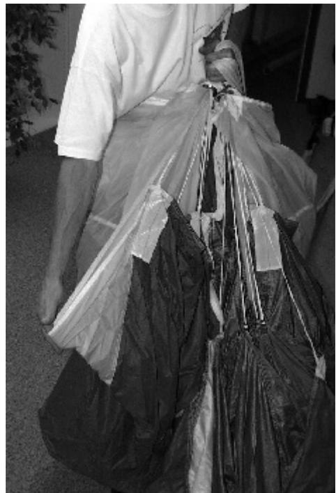
**#11** Greifen Sie nun nach unten und nehmen Sie die Steuerkante der Mittelzelle auf (siehe Markierung am Fallschirm) .
