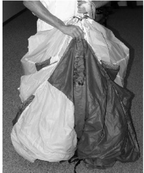
**#12** Ergreifen Sie nun den überschüssigen Stoff einer Hälfte der Steuerkante und ziehen denselben seitlich heraus.
