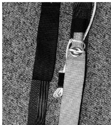
**#2a** Ergreifen Sie die vorderen und hinteren Fangleinenbündel sowie die Steuerleinen zwischen den Fingern und trennen diese wie abgebildet. Dabei laufen Sie in Richtung Kappe und schieben den voll entfalteten Slider vor sich her, gegen den Anschlag der Stabilisatoren.
