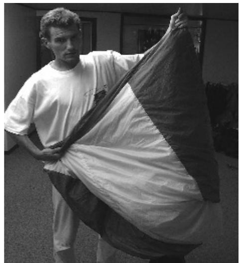
**#13** Danach schieben Sie die eben gefertigte Steuerkanten-Rolle in Richtung der Mittelzelle der Kappennase.
