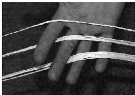
**#3** Achten Sie darauf, daß keine Verdrehungen, Überschläge oder Durchschläge im linken oder rechten Fangleinenbündel sind. Alle Leinen müssen kreuzungsfrei durch den Slider bis zur Kappe verlaufen. Ist dies nicht der Fall, sind die Leinenbündel zu entwirren.
